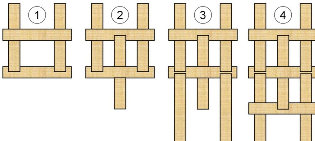
Nach dem vierten Schritt haben Sie bereits eine kleine Brücke gebaut. Beginnen Sie nun wieder bei Schritt 1, um die Brücke zu erweitern. Durch weiteres Legen von 5 Holzstäben kann die Spannweite der Brücke vergrößert werden.
